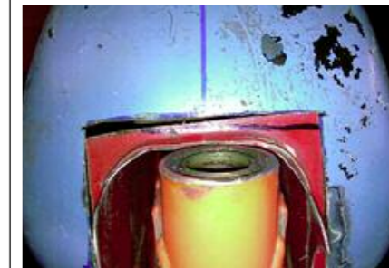
Anpassung von Oberteil eines Mokick-Eiertanks und Unterteil eines KS-125-Tanks
