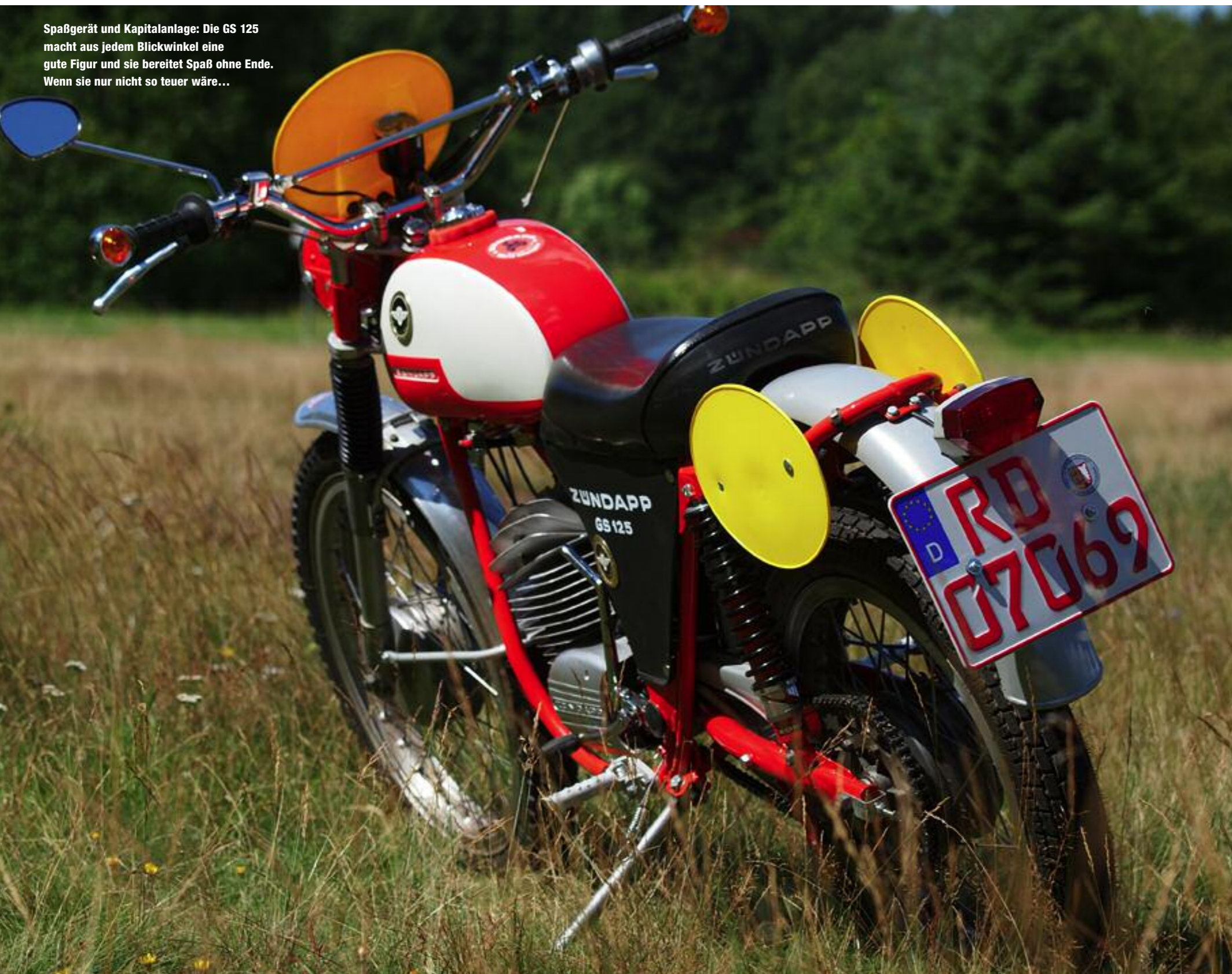
Anpassung von Oberteil eines Mokick-Eiertanks und Unterteil eines KS-125-Tanks
