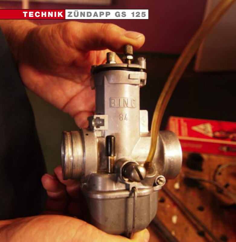
Sieht gut aus und säuft: Der originale 27er-Bing-Vergaser ließ sich kaum einstellen und flog raus
