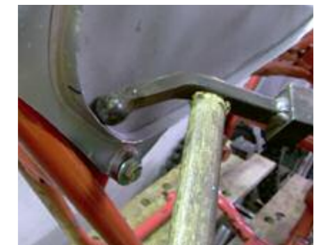
Für die Rundungen musste ein passender Karosseriehammer hergestellt werden
