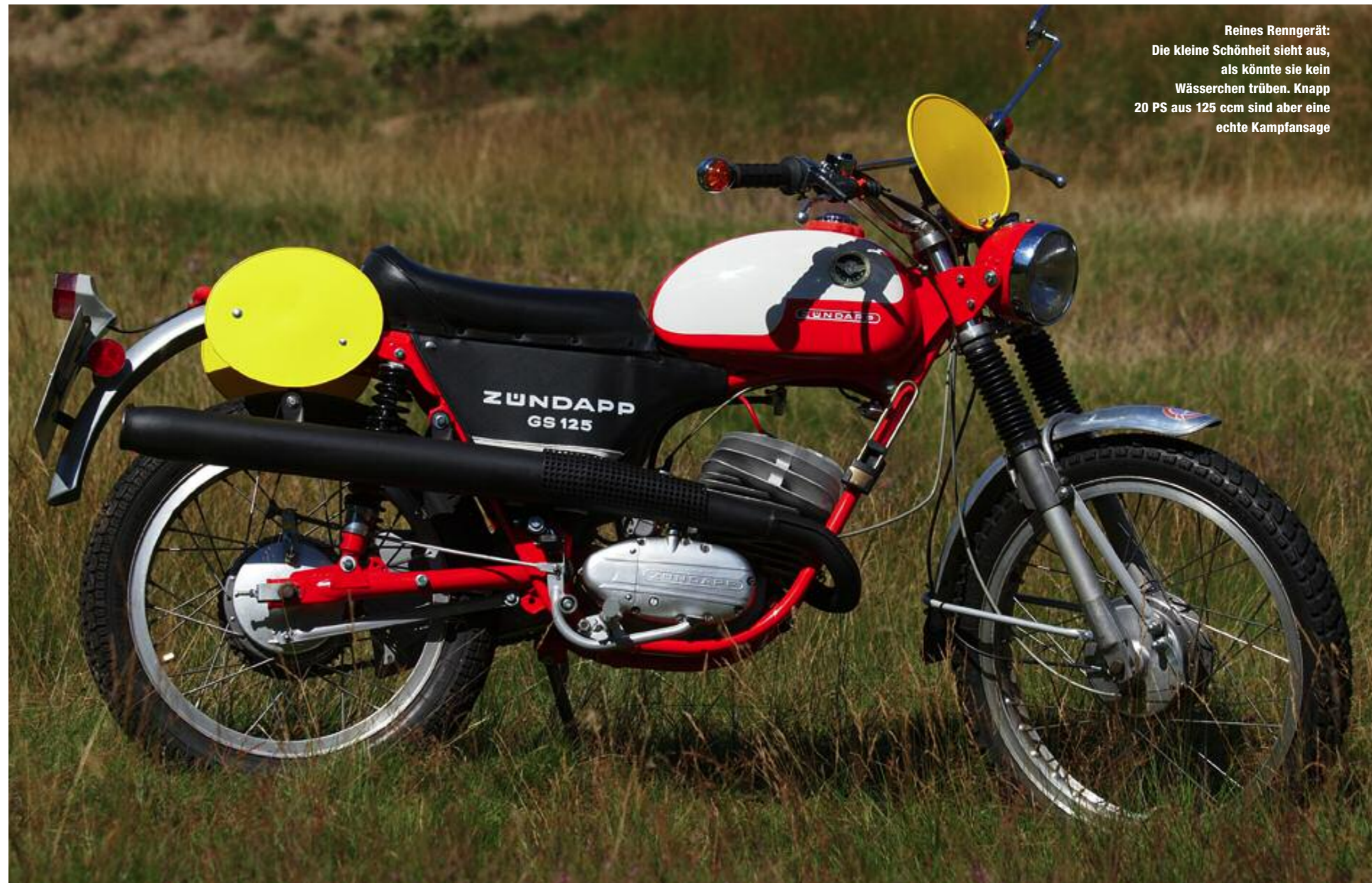
Sieht gut aus und säuft: Der originale 27er-Bing-Vergaser ließ sich kaum einstellen und flog raus
