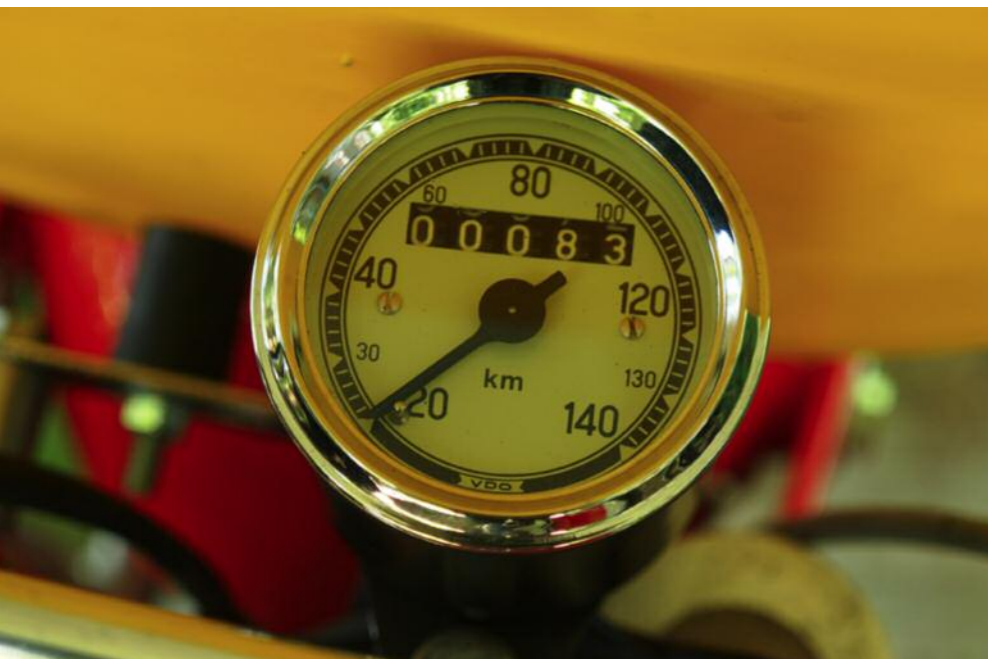
Praktisch nicht zu bekommen: Ein Tacho im Originalzustand musste aus drei Geräten zusammengesetzt werden
