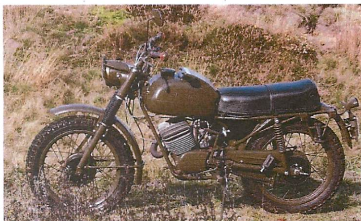
Unterzüge vom Lenkkopf zu den Fußrasten versteifen den Rahmen.
