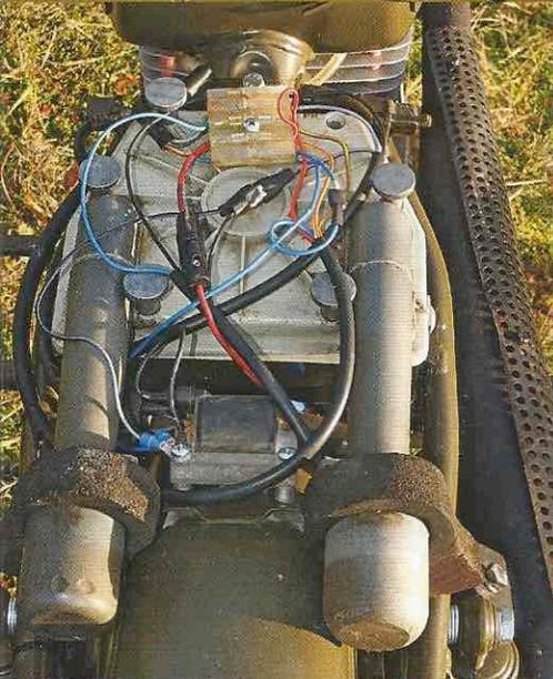
Die modifizierte Geländemaschine hatte einige Vorgaben zu erfüllen, wie zum Beispiel eine Werkzeugklappe im Tank. Die beiden langen Ansaugsnorchen wurden nach oben verlegt, um die Tiefwatfähigkeit zu erhöhen und das Motorinnere vor Feuchtigkeit zu schützen. Die Armaturen stammen von Magura
